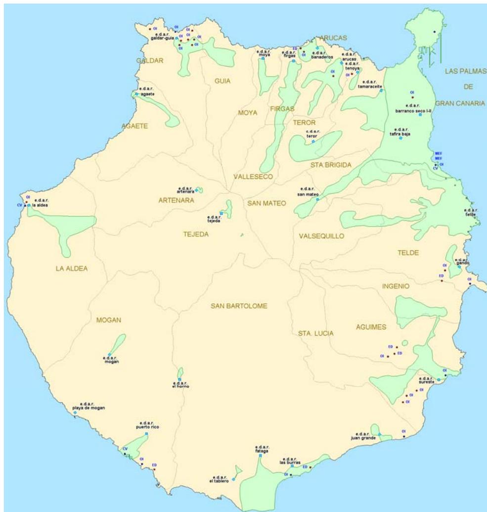
**Figura 8.** Situación de estaciones depuradoras de aguas residuales (EDAR), cuencas vertientes a EDAR (en verde) y estaciones desaladoras en la isla de Gran Canaria. Se indican en estas últimas el tipo de tecnología de desalación (OI: ósmosis inversa; ED: electrodialísis). CV: compresión de vapor; MEF: destilación multiefecto) y el agua de procedencia (salobre, en rojo; agua de mar, en azul) (Fuente: Consejo Insular de Aguas de Gran Canaria).
